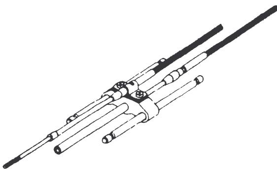
■ Appoggiare il tutto sulla piastra pre assemblata facendo attenzione ad inserire le guide e il terminale guaina del cavo (a) nelle apposite sedi sui semiblocchetti inferiori. Fissare quindi i semiblocchetti superiori tramite le apposite visi.
