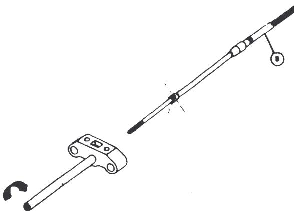
■ Fissare il cavo (b) sulla parte superiore del blocchetto scorrevole tramite le piastrine e le relative viti.
